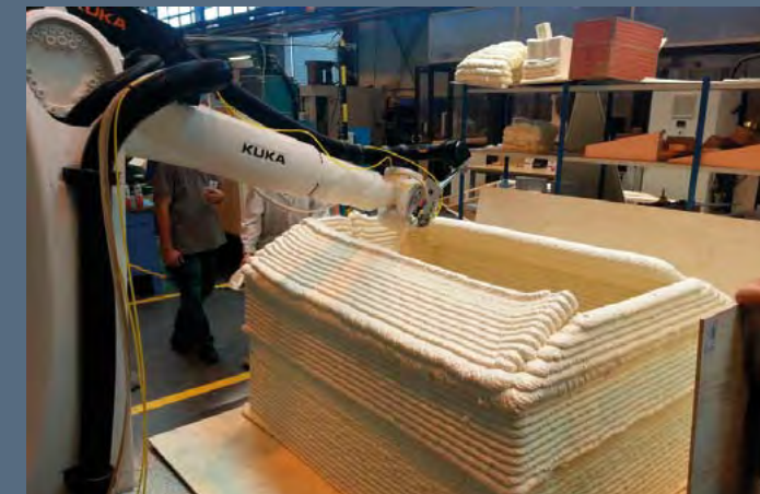
L'INNO print 3D en fonctionnement - © IRCCyN
